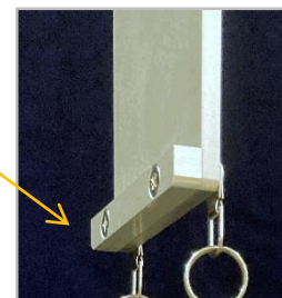
中央回路固定部 転落防止ストッパー
